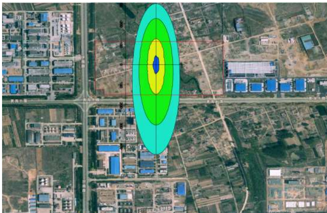
图4.2-37 跑冒滴漏下苯的污染晕范围
