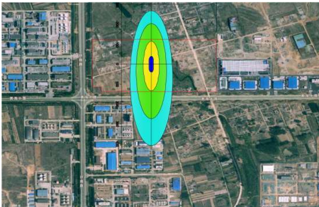
图4.2-36 跑冒滴漏情景下氰化物的污染晕预测图
