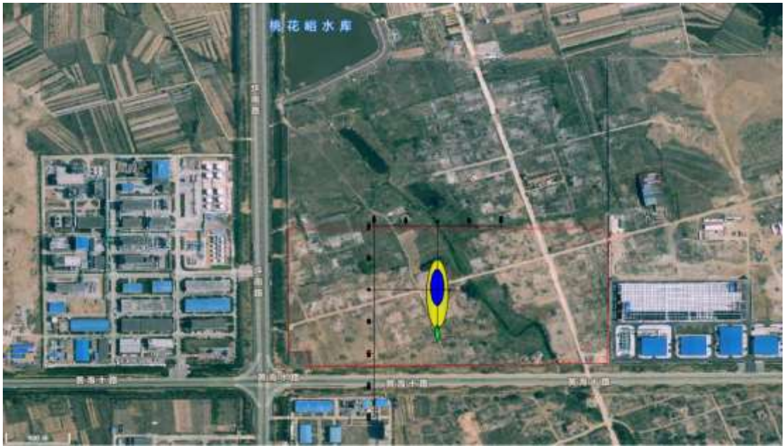
图4.2-31 事故发生后氰化物的污染晕预测图
